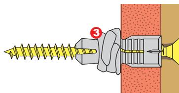
3. Grazie ad un nuovissimo schema alternato di fessure laterali il tassello SMART si annoda con estrema facilità su supporti cavi e si adatta perfettamente ad ogni tipo di materiale.
