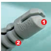
2. Il corpo del tassello SMART è dotato di profonde scanalature laterali che permettono un ancoraggio ottimale per compressione su materiali scarsamente compatti e grezzi.
